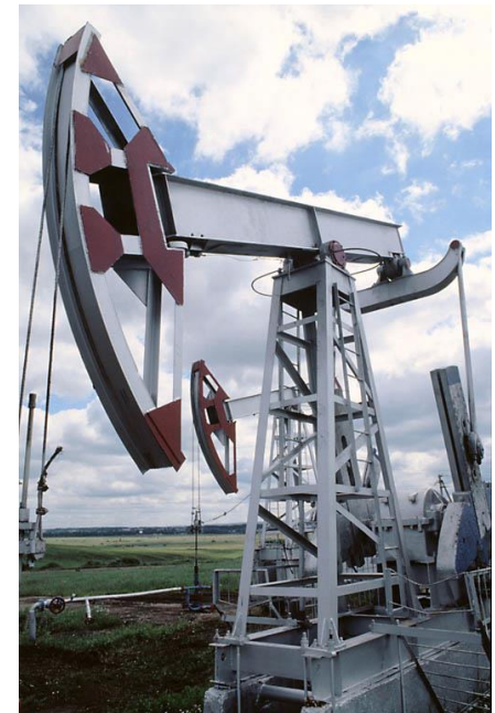
Erdölpumpe (Tiefenpumpe zur Förderung unterirdischer Flüssigkeiten)
